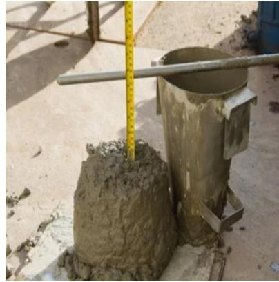
الشكل 5: اختبار الهبوط للخرسانة و جهاز اختبار مقاومة الضغط للخرسانة
